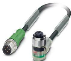
Câble pour capteurs/actionneurs, 4-pôles, connecteur mâle droit M12, détrompage: A, avec 3 LED, câblé avec déconnecté, sur Connecteur femelle coudé M12, détrompage: A, avec 3 LED, longueur de câble: 0,6 m
