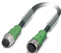
Câble pour capteurs/actionneurs, 8-pôles, connecteur mâle droit M12, détrompage: A, câblé avec déconnecté, sur Connecteur femelle droit M12, détrompage: A, longueur de câble: 0,3 m
