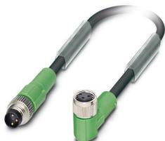
Câble pour capteurs/actionneurs, 3-pôles, connecteur mâle droit M8, détrompage: A, sur Connecteur femelle coudé M8, longueur de câble: 3 m
