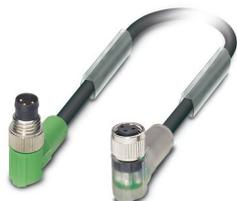
Câble pour capteurs/actionneurs, 3-pôles, connecteur mâle coudé M8, détrompage: A, avec 2 LED, sur Connecteur femelle coudé M8, avec 2 LED, longueur de câble: 3 m
