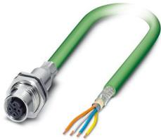
Connecteur d'appareil face arrière, PROFINET CAT5, 4-pôles, PVC, vert RAL 6018, Connecteur mâle, droit, M12, sur extrémité libre, Montage face arrière, 0,34 mm<sup>2</sup>, PROFINET, Produit de remplacement selon RoHS II sans exception 6c (Pb < 0,1 %) référence : 1239109
