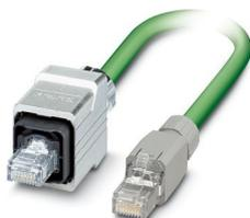
Câble PROFINET préconfectionné, CAT 5e, blindé, quarte en étoile, AWG 22 compatible avec les chaînes porte-câbles (7 fils), RAL 6018 (jaune-vert), connecteur mâle RJ45/IP67 boîtier métallique Push-Pull sur connecteur mâle RJ45/IP20, Line, longueur 5 m
