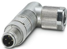
Connecteur de données, PROFINET CAT5 (100 Mbit/s), 4-pôles, blindé, connecteur mâle coudé M12, détrompage: D, Raccordement à sertir, matériau de la molette: Zinc moulé sous pression, étamé, diamètre extérieur du câble 4,5 mm ... 7,5 mm, sans contacts à sertir
