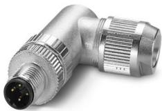
Connecteur, PROFINET CAT5 (100 Mbit/s), 4-pôles, blindé, connecteur mâle coudé M12, détrompage: D, Raccordement à ressort Push-Lock, matériau de la molette: Zinc moulé sous pression, nickelé, diamètre extérieur du câble 4 mm ... 8 mm
