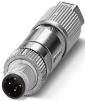
Connecteur de données, PROFINET CAT5 (100 Mbit/s), 4-pôles, exempt d'halogène, blindé, connecteur mâle droit M12, détrompage: D, Raccordement autodénudant, matériau de la molette: Zinc moulé sous pression, nickelé, diamètre extérieur du câble 5 mm ... 9,7 mm
