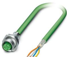
Connecteur d'appareil face arrière, PROFINET CAT5 (100 Mbit/s), EtherCAT® CAT5 (100 Mbit/s), 4-pôles exempt d'halogène, vert RAL 6018, blindé, connecteur femelle, droit, M12, détrompage: D, sur extrémité libre, Montage face arrière, Raccordement par cosse, longueur de câble: 2 m, Produit de remplacement selon RoHS II sans exception 6c (Pb < 0,1 %) référence : 1239110
