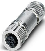
Connecteur, PROFINET CAT5 (100 Mbit/s), 4-pôles, blindé, connecteur femelle droit M12, détrompage: D, Raccordement à ressort Push-Lock, matériau de la molette: Zinc moulé sous pression, nickelé, diamètre extérieur du câble 4 mm ... 8 mm
