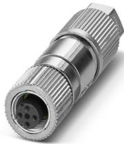
Connecteur de données, PROFINET CAT5 (100 Mbit/s), 4-pôles, exempt d'halogène, blindé, connecteur femelle droit M12, détrompage: D, Raccordement autodénudant, matériau de la molette: Zinc moulé sous pression, nickelé, diamètre extérieur du câble 5 mm ... 9,7 mm
