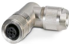
Connecteur de données, PROFINET CAT5 (100 Mbit/s), 4-pôles, blindé, connecteur femelle coudé M12, détrompage: D, Raccordement autodénudant, matériau de la molette: Laiton, nickelé, diamètre extérieur du câble 4 mm ... 8 mm
