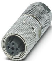
Connecteur de données, PROFINET CAT5 (100 Mbit/s), 4-pôles, blindé, connecteur femelle droit M12, détrompage: D, Raccordement à sertir, matériau de la molette: Zinc moulé sous pression, étamé, diamètre extérieur du câble 4,5 mm ... 7,5 mm, sans contacts à sertir
