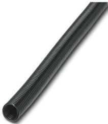
Tube de protection, matériau: PA 6, résistant aux UV: oui, souple, indice de protection: IP68, coloris: noir, classe d'inflammabilité selon UL 94: V0, diamètre intérieur: 10 mm, Longueur totale: 50 m
