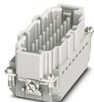
Élément de contact, nombre de pôles: 16+PE, taille: B16, nombre de raccordements par pôle: 1, Mâle, Raccordement Push-in, 500 V, 16 A, 0,14 mm<sup>2</sup> ... 2,5 mm<sup>2</sup>, application: Puissance
