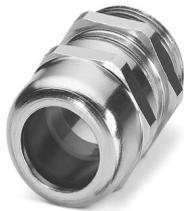
Presse-étoupe, matériau du raccordement vissé: Laiton, nickelé, diamètre extérieur du câble 11 mm ... 17 mm, blindage: non, filetage de raccordement: M25 x 1,5, coloris: argenté, avec joint torique
