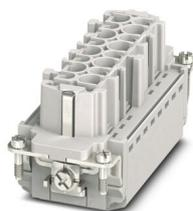
Élément de contact, nombre de pôles: 16+PE, taille: B16, nombre de raccordements par pôle: 1, Connecteur femelle, Raccordement Push-in, 500 V, 16 A, 0,14 mm<sup>2</sup> ... 2,5 mm<sup>2</sup>, application: Puissance
