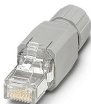
Connecteur RJ45, type: RJ45, indice de protection: IP20, nombre de pôles: 4, 100 Mbit/s, CAT5, matériau: Plastique, type de raccordement: Raccordement autodénudant, sortie du câble: droit, coloris: gris signalisation A RAL 7042, PROFINET
