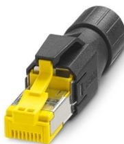
Connecteur RJ45, type: RJ45, indice de protection: IP20, nombre de pôles: 8, 10 Gbit/s, CAT6<sub>A</sub>, matériau: Plastique, type de raccordement: Raccordement autodénudant, section raccordable: AWG 26- 24, sortie du câble: droit, coloris: noir, Ethernet
