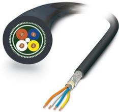
Câble de données, PROFINET CAT5 (100 Mbit/s), 4-pôles exempt d'halogène, blindé, extrémité libre, sur extrémité libre, longueur de câble: 100 m
