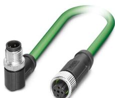
Câble de réseau, PROFINET CAT5 (100 Mbit/s), EtherCAT® CAT5 (100 Mbit/s), 4-pôles, blindé (Advanced Shielding Technology), connecteur mâle coudé M12, détrompage: D / IP67, sur Connecteur femelle droit M12, détrompage: D / IP67, longueur de câble: 5 m
