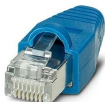
Connecteur RJ45, type: RJ45, indice de protection: IP20, nombre de pôles: 8, 1 Gbit/s, CAT5 (CEI 11801:2002), matériau: Plastique, type de raccordement: Raccordement à sertir, section raccordable: AWG 26- 24, sortie du câble: droit, Ethernet
