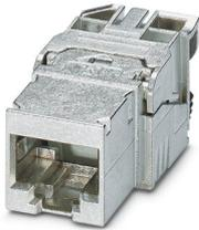
Isolant femelle RJ45, type: RJ45, indice de protection: IP20, nombre de pôles: 8, 10 Gbit/s, CAT6<sub>A</sub>, matériau: Métal, type de raccordement: Raccordement IDC, section raccordable: AWG 26- 22, sortie du câble: droit, Modèle sans adaptateur, Ethernet
