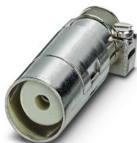
Connecteur, nombre de pôles: 1, contacts de puissance: 0, contacts de commande: 1, Mâle, Raccordement à sertir, 48 V, 16 A, 0,5 mm<sup>2</sup> ... 4 mm<sup>2</sup>, diamètre extérieur du câble:3 mm ... 9,5 mm, application: COAX, 50 Ω
