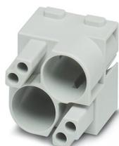
Module à élément de contact, nombre de pôles: 2, Connecteur femelle, Raccordement à sertir, 48 V, 10 A, 0,14 mm<sup>2</sup> ... 2,5 mm<sup>2</sup>, application: Données/Signaux, pour utiliser deux connecteurs CEM (connecteur femelle), nombre de pôles : 1, 4, 8
