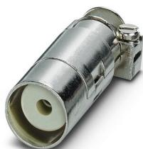
Connecteur, nombre de pôles: 1, contacts de puissance: 0, contacts de commande: 1, Mâle, Raccordement à sertir, 48 V, 10 A, 0,14 mm<sup>2</sup> ... 2,5 mm<sup>2</sup>, diamètre extérieur du câble:3 mm ... 9,5 mm, application: COAX, 75 Ω
