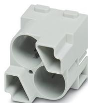
Module à élément de contact, nombre de pôles: 2, Mâle, Raccordement à sertir, 48 V, 10 A, 0,14 mm<sup>2</sup> ... 2,5 mm<sup>2</sup>, application: Données/Signaux, pour utiliser deux connecteurs CEM (connecteur mâle), nombre de pôles : 1, 4, 8
