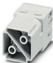
Module à élément de contact, nombre de pôles: 2, contacts de puissance: 2, contacts de commande: 0, Mâle, Raccordement vissé axial, 1000 V, 100 A, 10 mm<sup>2</sup> ... 35 mm<sup>2</sup>, application: Puissance
