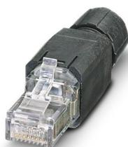
Connecteur RJ45, type: RJ45, indice de protection: IP20, nombre de pôles: 8, 1 Gbit/s, CAT5 (CEI 11801:2002), matériau: Plastique, type de raccordement: Raccordement autodénudant, section raccordable: AWG 26- 23, sortie du câble: droit, coloris: noir, Ethernet
