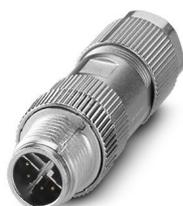
Connecteur de données, Ethernet CAT6<sub>A</sub> (10 Gbit/s), 8-pôles, blindé, connecteur mâle droit M12 SPEEDCONNEC, détrompage: X, Raccordement rapide Piercecon<sup>®</sup>, matériau de la molette: Zinc moulé sous pression, nickelé, diamètre extérieur du câble 4 mm ... 8 mm
