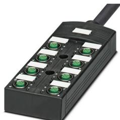
Répartiteur pour capteurs/actionneurs, application : robots et chaînes porte-câble, type de raccordement : connecteur femelle M12 SPEEDCONNEC en métal, nombre d'emplacements : 8, nombre de pôles : 5, affectation des connecteurs : double, voyant de diagnostic et d'état : oui, plug and play, raccordement de la ligne principale : raccordement fixe 180°, PUR exempt d'halogène, ultra-souple, longueur du câble : 7 m, blindage : non
