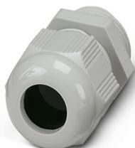
Presse-étoupe, matériau du raccordement vissé: PA, diamètre extérieur du câble 11 mm ... 17 mm, blindage: non, filetage de raccordement: M25 x 1,5, coloris: gris clair RAL 7035
