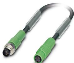
Câble pour capteurs/actionneurs, 3-pôles exempt d'halogène, connecteur mâle droit M8, détrompage: A, sur Connecteur femelle droit M8 Snap-in, longueur de câble: 1 m
