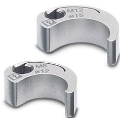
Embout enfichable pour le montage de câbles de capteurs/actionneurs munis de connecteurs M12 et de connecteurs M12 à équiper avec diamètre d'écrou moleté de 15 mm, pour emmanchement à six pans de 4 mm
