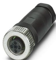
Connecteur de puissance, 4-pôles, non blindé, connecteur femelle droit M12, T, Raccordement vissé, matériau de la molette: Zinc moulé sous pression, nickelé, presse-étoupe Pg9, diamètre extérieur du câble 6 mm ... 8 mm, pour courant continu jusqu'à 12 A/63 V
