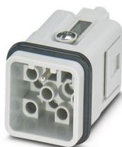
Élément de contact, nombre de pôles: 12+PE, taille: D7, nombre de raccordements par pôle: 1, Mâle, Raccordement à sertir, 400 V, 12 A, 0,14 mm<sup>2</sup> ... 2,5 mm<sup>2</sup>
