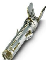
Contact à sertir, diamètre de contact: 1,6 mm, roulés, Connecteur femelle, matériau de contact: Alliage Cu, nickelé, surface des contacts: plaqué argent, section raccordable: 1,5 mm<sup>2</sup> ... 2,5 mm<sup>2</sup>, AWG 16 ... 14
