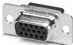
Porte-contacts D-SUB , taille Shell 1, pour 15 contacts de signalisation, type de contact femelle, pour contacts à sertir, droit, fixation au moyen d'un perçage de 3 mm, pour cadre de montage et capot VS-09-...
