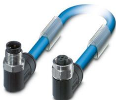
Câble préconfectionné pour bus, PROFIBUS PA (31,25 kbit/s), 3-pôles, blindé, connecteur mâle coudé M12, détrompage: B, sur Connecteur femelle coudé M12, détrompage: A, longueur de câble: 5 m, pour zone Ex avec molette inox
