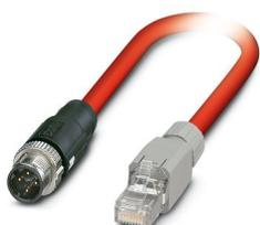
Câble préconfectionné pour bus, Sercos CAT5 (100 Mbit/s), 4-pôles, connecteur mâle droit M12 SPEEDCONNEC, détrompage: D / IP67, sur connecteur mâle droit RJ45 / IP20, longueur de câble: 2 m
