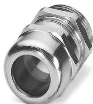
Presse-étoupe, matériau du raccordement vissé: Laiton, nickelé, diamètre extérieur du câble 6 mm ... 12 mm, blindage: non, filetage de raccordement: M20 x 1,5, coloris: argenté, avec joint torique
