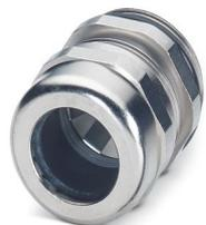
Presse-étoupe, matériau du raccordement vissé: Laiton, nickelé, diamètre extérieur du câble 9 mm ... 13 mm, blindage: oui, filetage de raccordement: M20 x 1,5, coloris: argenté, avec joint torique
