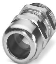
Presse-étoupe, matériau du raccordement vissé: Laiton, nickelé, diamètre extérieur du câble 5 mm ... 10 mm, blindage: non, filetage de raccordement: Pg11, coloris: argenté, avec joint torique
