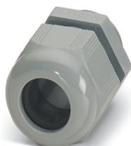
Presse-étoupe, matériau du raccordement vissé: PA, diamètre extérieur du câble 5 mm ... 10 mm, blindage: non, filetage de raccordement: Pg11, coloris: gris argent RAL 7001
