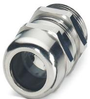
Presse-étoupe, matériau du raccordement vissé: Laiton, nickelé, diamètre extérieur du câble 5 mm ... 10 mm, blindage: oui, filetage de raccordement: Pg11, coloris: argenté, avec joint torique
