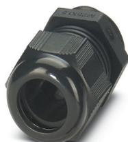
Presse-étoupe, matériau du raccordement vissé: PA, diamètre extérieur du câble 5 mm ... 10 mm, blindage: non, filetage de raccordement: Pg11, coloris: noir foncé RAL 9005
