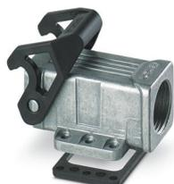
Embase en saillie D7, avec étrier longitudinal, matériau: Aluminium coulé sous pression, résistant à l'eau de mer, nombre de sorties: 1, droit, 1x M20, hauteur: 27,9 mm, presse-étoupe: sans, Standard, Fond ouvert
