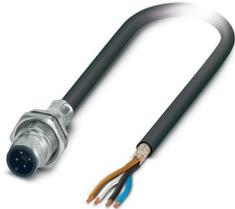
Connecteur d'appareil face arrière, Universel, 4-pôles, PUR, gris-noir RAL 7021, blindé, Connecteur mâle, droit, M12-SPEEDCONNEC, détrompage: A, sur extrémité libre, Montage face arrière, M16 x 1,5, Raccordement de câble, longueur de câble: 1 m, PUR exempt d'halogène noir, Produit de remplacement selon RoHS II sans exception 6c (Pb < 0,1 %) référence : 1239252
