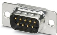
Isolant pour contact D-SUB , taille Shell 1, avec 9 contacts de signalisation, type de contact mâle, avec cône de soudage, droit, fixation au moyen d'un perçage de 3 mm, pour cadre de montage et capot VS-09-...
