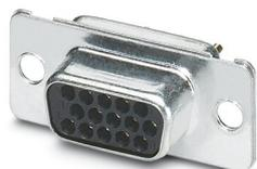
Isolant pour contact D-SUB , taille Shell 1, avec 15 contacts de signalisation, type de contact femelle, avec cône de soudage, droit, fixation au moyen d'un perçage de 3 mm, pour cadre de montage VS-09-...
