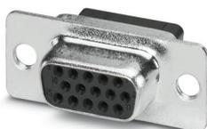
Porte-contacts D-SUB , taille Shell 1, pour 15 contacts de signalisation, type de contact femelle, pour contacts à sertir, droit, fixation au moyen d'un perçage de 3 mm, pour cadre de montage et capot VS-09-...
