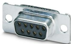
Isolant pour contact D-SUB , taille Shell 1, avec 9 contacts de signalisation, type de contact femelle, avec cône de soudage, droit, fixation au moyen d'un perçage de 3 mm, pour cadre de montage et capot VS-09-...
