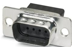
Porte-contacts D-SUB , taille Shell 1, pour 9 contacts de signalisation, type de contact mâle, pour contacts à sertir, droit, fixation au moyen d'un perçage de 3 mm, pour cadre de montage et capot VS-09-...
