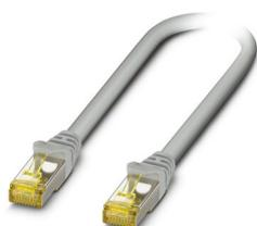
Câble de jonction, indice de protection: IP20, longueur de câble: 2 m, nombre de pôles: 8, 10 Gbit/s, CAT6<sub>A</sub>, type de raccordement: Raccordement Pierce, section raccordable: AWG 26- 26, sortie du câble: droit, Ethernet
