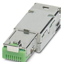
Isolant mâle RJ45, type: RJ45, indice de protection: IP20, nombre de pôles: 8, 1 Gbit/s, CAT5 (CEI 11801:2002), matériau: Métal, type de raccordement: Raccordement autodénudant, section raccordable: AWG 23- 22, sortie du câble: droit, Ethernet / PROFINET
