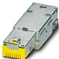
Isolant mâle RJ45, type: RJ45, indice de protection: IP20, nombre de pôles: 8, 10 Gbit/s, CAT6<sub>A</sub> (CEI 60512-27-100:2008, TIA-568-C.2:2009), matériau: Métal, type de raccordement: Raccordement autodénudant, section raccordable: AWG 26- 24, sortie du câble: droit, Ethernet
