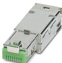
Isolant mâle RJ45, type: RJ45, indice de protection: IP20, nombre de pôles: 8, 1 Gbit/s, CAT5 (CEI 11801:2002), matériau: Métal, type de raccordement: Raccordement autodénudant, section raccordable: AWG 26- 24, sortie du câble: droit, Ethernet
