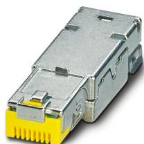
Isolant mâle RJ45, type: RJ45, indice de protection: IP20, nombre de pôles: 8, 10 Gbit/s, CAT6<sub>A</sub> (CEI 60512-27-100:2008, TIA-568-C.2:2009), matériau: Métal, type de raccordement: Raccordement autodénudant, section raccordable: AWG 23- 22, sortie du câble: droit, Ethernet
