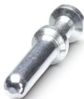
Contact à sertir, diamètre de contact: 4 mm, tournés, Mâle, matériau de contact: Alliage de cuivre, surface des contacts: plaqué argent, section raccordable: 1,5 mm<sup>2</sup> ... 1,5 mm<sup>2</sup>, AWG 16
