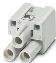
Élément de contact, nombre de pôles: 2+PE, taille: D7, nombre de raccordements par pôle: 1, Connecteur femelle, Raccordement à sertir, 400 V, 40 A, 1,5 mm<sup>2</sup> ... 6 mm<sup>2</sup>, application: Puissance
