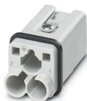
Élément de contact, nombre de pôles: 2+PE, taille: D7, nombre de raccordements par pôle: 1, Mâle, Raccordement à sertir, 400 V, 40 A, 1,5 mm<sup>2</sup> .. 6 mm<sup>2</sup>, application: Puissance
