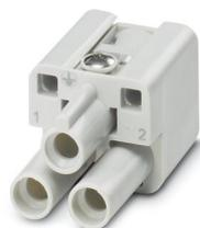
Élément de contact, nombre de pôles: 2+PE, taille: D7, nombre de raccordements par pôle: 1, Connecteur femelle, Raccordement à sertir, 400 V, 40 A, 1,5 mm<sup>2</sup> ... 6 mm<sup>2</sup>, application: Puissance
