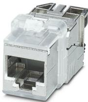
Isolant femelle RJ45, type: RJ45, indice de protection: IP20, nombre de pôles: 8, 10 Gbit/s, CAT6<sub>A</sub>, matériau: Métal, type de raccordement: Raccordement IDC, section raccordable: AWG 26- 22, sortie du câble: droit, Exécution keystone uniquement utilisable avec un cadre IP20 ou une intégration directe sur la paroi du boîtier, Ethernet
