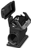
Embase en saillie B16, avec étrier longitudinal, matériau: PA, matériau du couvercle de protection: PC, nombre de sorties: 2, latérale, 2x M32, hauteur: 84 mm, presse-étoupe: sans, capot de protection: oui, Standard, y compris 2x adaptateurs réducteurs
