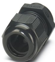
Presse-étoupe, matériau du raccordement vissé: PA, diamètre extérieur du câble 11 mm ... 17 mm, blindage: non, filetage de raccordement: M25 x 1,5, coloris: noir foncé RAL 9005
