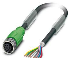
Câble pour capteurs/actionneurs, 8 pôles, PVC, gris noir RAL 7021, blindé, extrémité libre, sur connecteur femelle droit M12, détrompage A, longueur de câble : 10,0 m
