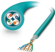
Câble de données, Ethernet CAT5 (1 Gbit/s), 8-pôles exempt d'halogène, blindé, extrémité libre, sur extrémité libre, longueur de câble: Longueur au choix (0,5 ... 400 m)
