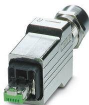
Connecteur RJ45, indice de protection: IP65/IP67, nombre de pôles: 8, 1 Gbit/s, CAT5 (CEI 11801:2002), matériau: Métal, type de raccordement: Raccordement autodénudant IDC, section raccordable: AWG 26- 24, sortie du câble: droit
