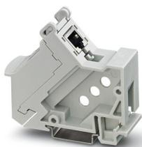
Adaptateur de montage sur profilé, indice de protection: IP20, nombre de pôles: 8, 1 Gbit/s, CAT6, matériau: PC-GF, type de raccordement: Raccordement autodénudant IDC, section raccordable: AWG 24- 22, coloris: gris
