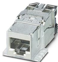
Isolant femelle RJ45, type: RJ45, indice de protection: IP20, nombre de pôles: 8, 10 Gbit/s, CAT6<sub>A</sub>, matériau: Métal, type de raccordement: Raccordement IDC, section raccordable: AWG 26- 22, sortie du câble: droit, Exécution Freenet pour une utilisation avec des cadres IP67 et des blocs de prise, Ethernet
