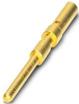
Contact à sertir, Mâle, tournés, diamètre de contact: 1 mm, zone de sertissage: 0,25 mm<sup>2</sup> ... 0,5 mm<sup>2</sup>, Produit de remplacement selon RoHS II sans exception 6c (Pb < 0,1 %) référence : 1239377
