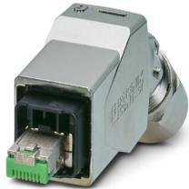
Connecteur RJ45, indice de protection: IP65/IP67, nombre de pôles: 8, 1 Gbit/s, CAT5 (CEI 11801:2002), matériau: Métal, type de raccordement: Raccordement autodénudant IDC, section raccordable: AWG 23- 22, sortie du câble: coudé
