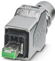
Connecteur RJ45, indice de protection: IP65/IP67, nombre de pôles: 8, 1 Gbit/s, CAT5 (CEI 11801:2002), matériau: Métal, type de raccordement: Raccordement autodénudant IDC, section raccordable: AWG 26- 24, sortie du câble: droit
