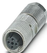
Connecteur de données, PROFINET CAT5 (100 Mbit/s), 4-pôles, blindé, connecteur femelle droit M12, détrompage: D, Raccordement à sertir, matériau de la molette: Zinc moulé sous pression, étamé, diamètre extérieur du câble 4,5 mm ... 7,5 mm, sans contacts à sertir
