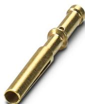
Contact à sertir, diamètre de contact: 1 mm, tournés, Connecteur femelle, matériau de contact: CuZn, surface des contacts: Ni/Au, section raccordable: 0,14 mm<sup>2</sup> ... 0,34 mm<sup>2</sup>, AWG 26 ... 22
