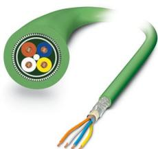
Câble de données, PROFINET CAT5 (100 Mbit/s), 4-pôles exempt d'halogène, blindé, extrémité libre, sur extrémité libre, longueur de câble: Longueur au choix (0,5 ... 100 m)
