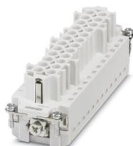
Élément de contact, nombre de pôles: 24+PE, taille: B24, nombre de raccordements par pôle: 2, Connecteur femelle, Raccordement Push-in, 500 V, 16 A, 0,25 mm<sup>2</sup> ... 1,5 mm<sup>2</sup>, application: Puissance
