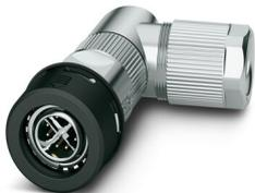
Connecteur de données, Ethernet CAT6<sub>A</sub> (10 Gbit/s), PROFINET CAT6<sub>A</sub> (10 Gbit/s), 8-pôles, blindé, connecteur mâle coudé M12 Push-Pull, X, Raccordement à sertir, matériau de la molette: PA 6.6, diamètre extérieur du câble 6,5 mm ... 10 mm, sans contacts à sertir
