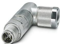
Connecteur de données, Ethernet CAT6<sub>A</sub> (10 Gbit/s), PROFINET CAT6<sub>A</sub> (10 Gbit/s), 8-pôles, blindé, connecteur mâle coudé M12, X, Raccordement à sertir, matériau de la molette: Zinc moulé sous pression, étamé, diamètre extérieur du câble 6,5 mm ... 10 mm, sans contacts à sertir
