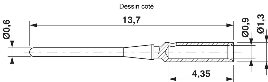
Contact à sertir, diamètre : 0,6 mm
