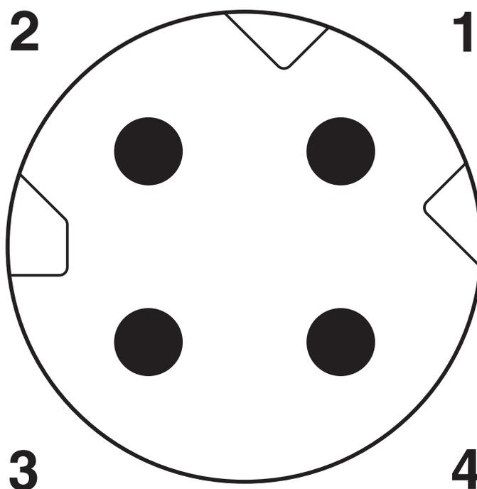
Brochage connecteur mâle M8, 4 pôles, détrompage D, vue côté mâle
