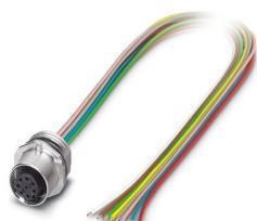
Embases paroi avant, Universel, 8-pôles, connecteur femelle, droit, M12-SPEEDCONNEC, détrompage: A, sur extrémité libre, Montage sur face avant, M16 x 1,5, Cordons individuels, longueur de câble: 1,2 m, 0,25 mm<sup>2</sup>, Cordon TPE, Produit de remplacement selon RoHS II sans exception 6c (Pb < 0,1 %) référence : 1239424
